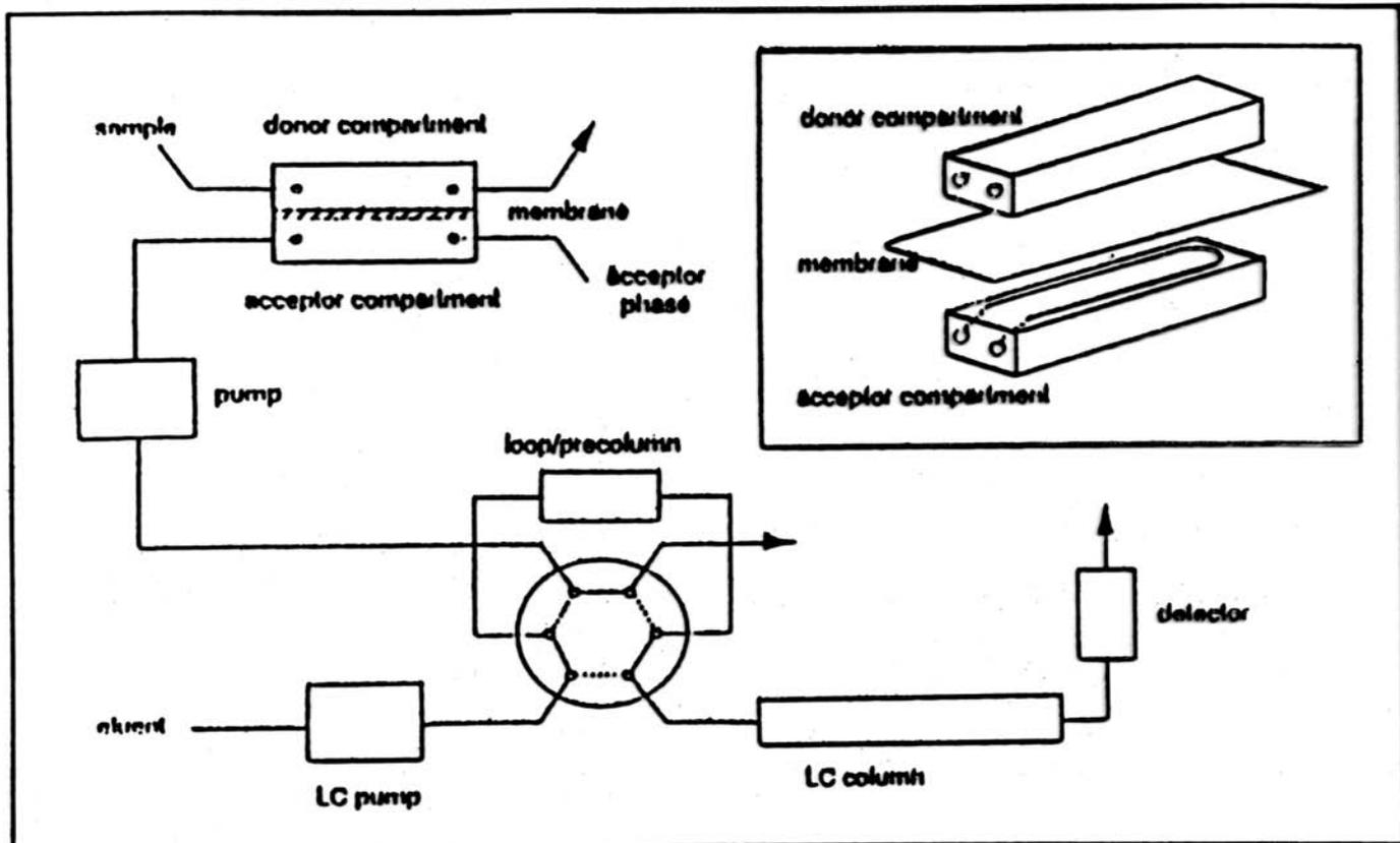
Schematické uspořádání on-line dialýzy vzorku děleného kapalinovou chromatografií
